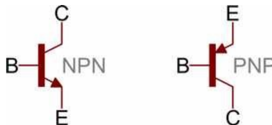
De circuitsymbolen voor de NPN- en de PNP-transistors
